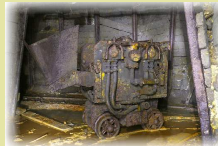
nakladač NL-12 zanechaný v štôlni Budúcnosť. stav v roku 2016
